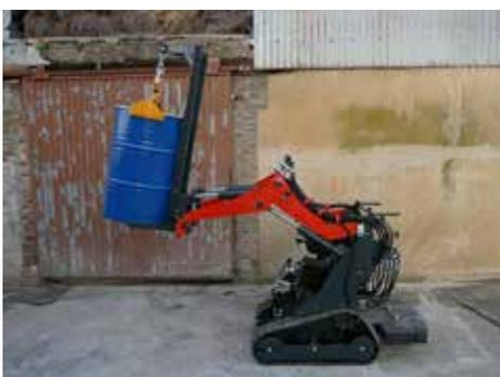
Préhenseur à fût 220L standardisé. permet le levage et le gerbage de fût. Pour une masse supérieure à 200kg, il peut être nécessaire d'utiliser le contrepois de plate-forme supplémentaire (nous consulter).
