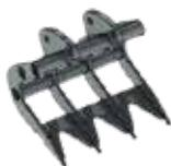
Le godet à claire-voie de 30cm est spécialisé dans l'arrachage de pieds de vignes. Ce dernier permet d'arracher dans le rang de gauche ou le rang de droite, sans que le bras n'ait à aller à la verticale des lignes de palissage. Il permet en outre le décavaillonnage de sol moyen à dur.
