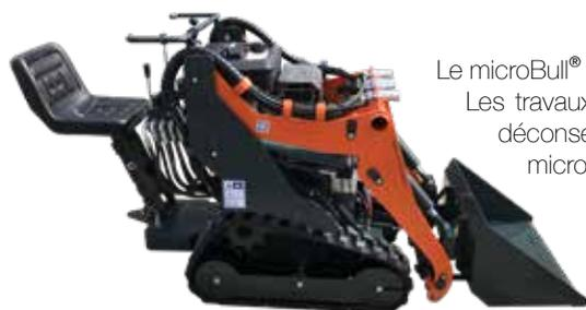
Le microBull® peut être équipé d'un siège pour les travaux courants de déblaiement, par exemple. Les travaux viticoles peuvent également être facilités par l'emploi de cet accessoire. Nous déconseillons l'utilisation du siège pour les opérations de curage de boxes, la longueur du microBull devenant trop proche des dimensions classiques de boxes.
