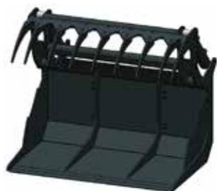
Benne à grappin (godet pélican) à fond fermé et grappin hydraulique destinée au curage de boxes à chevaux. La cinématique du grappin permet de ne pas griffer les parois lors de la fermeture et de maximiser le compactage.
