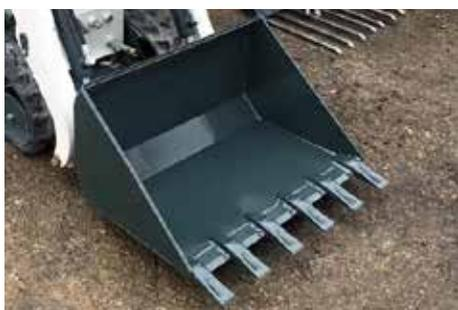
Godet de terrassement avec dents et lame d'attaque. Permet de décaillonner et de charger les sols difficiles. Attention, ce godet n'a pas la «polyvalence» d'un godet chargeur vrac, notamment pour les capacités de nivelage en marche arrière.
