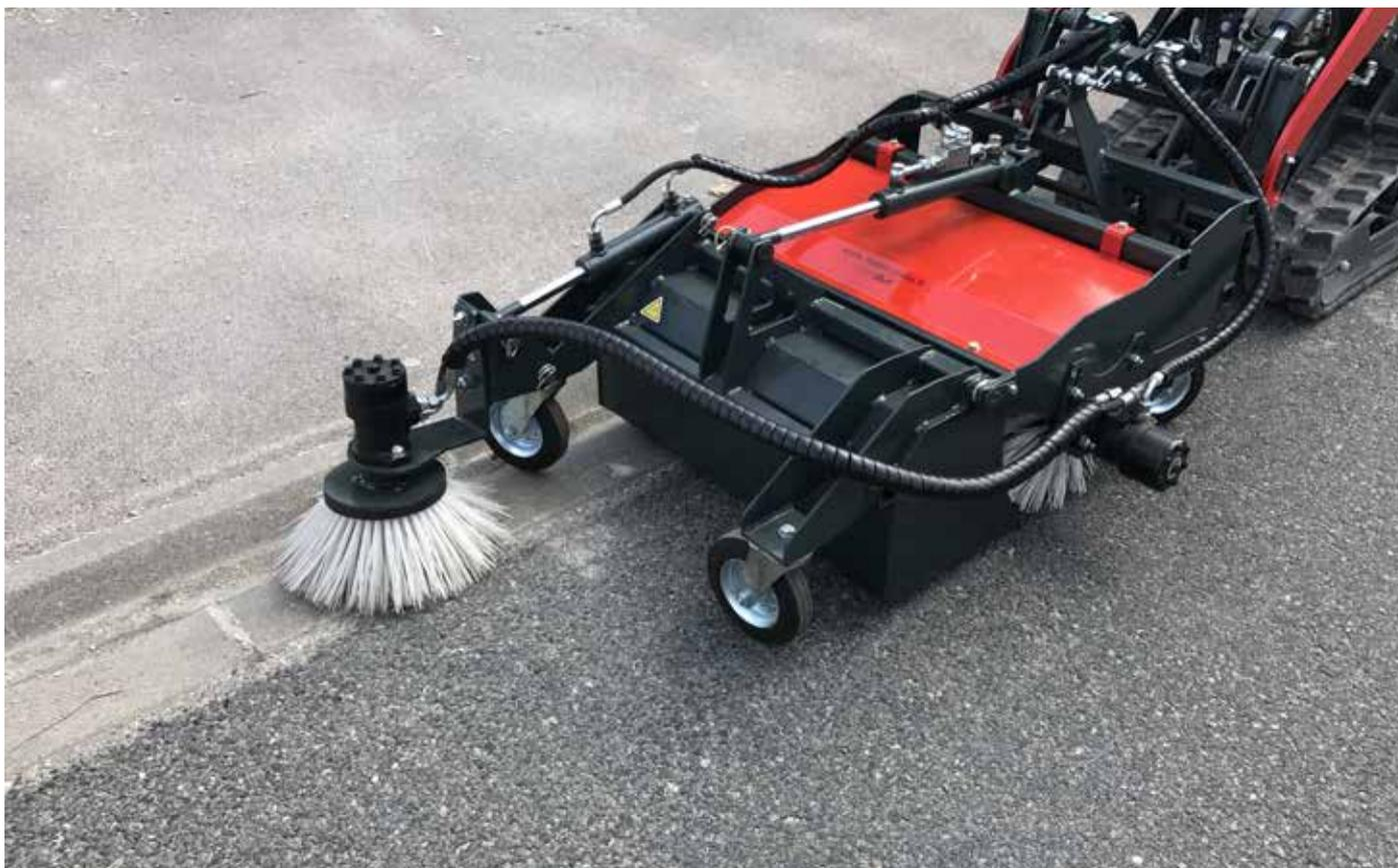
**Balayeuse à axe horizontal pour microBull, avec brosse latérale et bac récupérateur**
