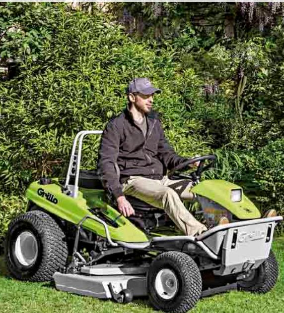
Le levier "Quick Shift" permet de passer rapidement entre Mulching et éjection arrière en restant assis et sans arrêter le travail et, surtout, sans devoir changer les lames.
