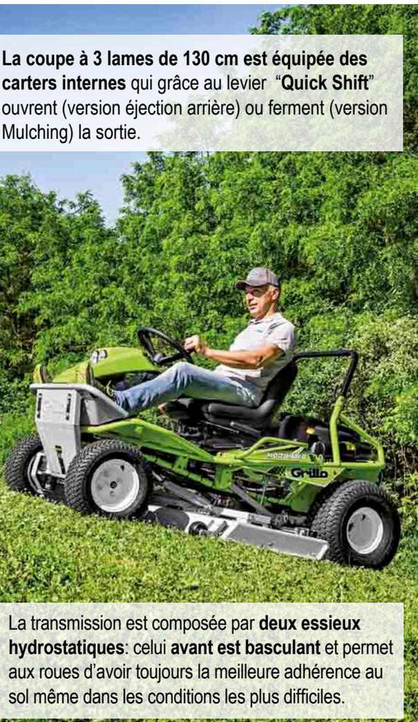
La transmission est composée par deux essieux hydrostatiques: celui avant est basculant et permet aux roues d'avoir toujours la meilleure adhérence au sol même dans les conditions les plus difficiles.
