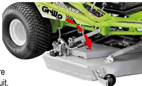
MD 22N et MD 24 AWD sont équipés avec une coupe de 110 cm, tandis que pour la MD 28 AWD de 130 cm, les deux avec un levier "Quick Shift", pour le passage rapide entre Mulching et éjection arrière directement du poste de conduit.
