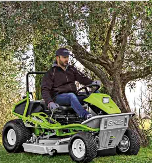
La transmission est composée par deux essieux hydrostatiques: celui avant est basculant et permet aux roues d'avoir toujours la meilleure adhérence au sol même dans les conditions les plus difficiles.
