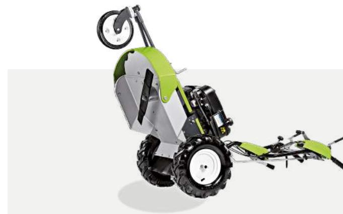
Ce modèle peut être positionné très aisément à la verticale en posant le guidon par terre. **L'entretien et le nettoyage du plateau** sont donc simples et rapides.
