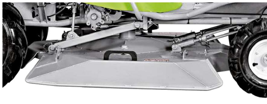
Le **porte lames en acier spécial** est monté avec couteaux escamotables à double tranchant: on peut, donc, augmenter leur durée de vie en renversant la position. La lame a un dessin spécial pour réduire le bruit et diminuer la puissance absorbée.
