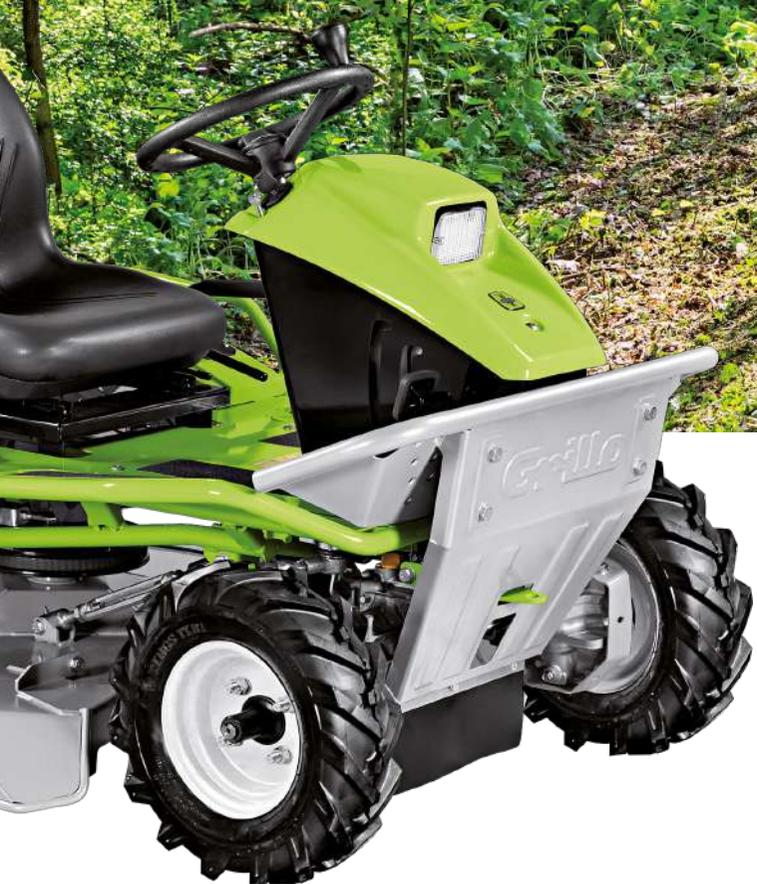
**La hauteur de coupe** se règle par un levier assisté avec système de verrouillage de la hauteur dans n'importe quelle position. Le plateau est bloqué lorsqu'on relâche le levier. **L'embrayage des lames est électromagnétique** avec frein de lame intégré et l'enclenchement s'effectue par un bouton à côté du volant. La largeur de travail est de 93 cm pour le modèle 10.22 et 98 cm pour le 10.27.
