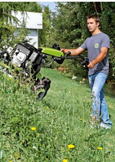
Pour les travaux en pente on peut bloquer la roue avant en améliorant considérablement la souplesse de la machine; de plus le moteur est équipé d'une pompe à lubrification forcée qui permet de travailler dans la pente sans problèmes pour le moteur.
