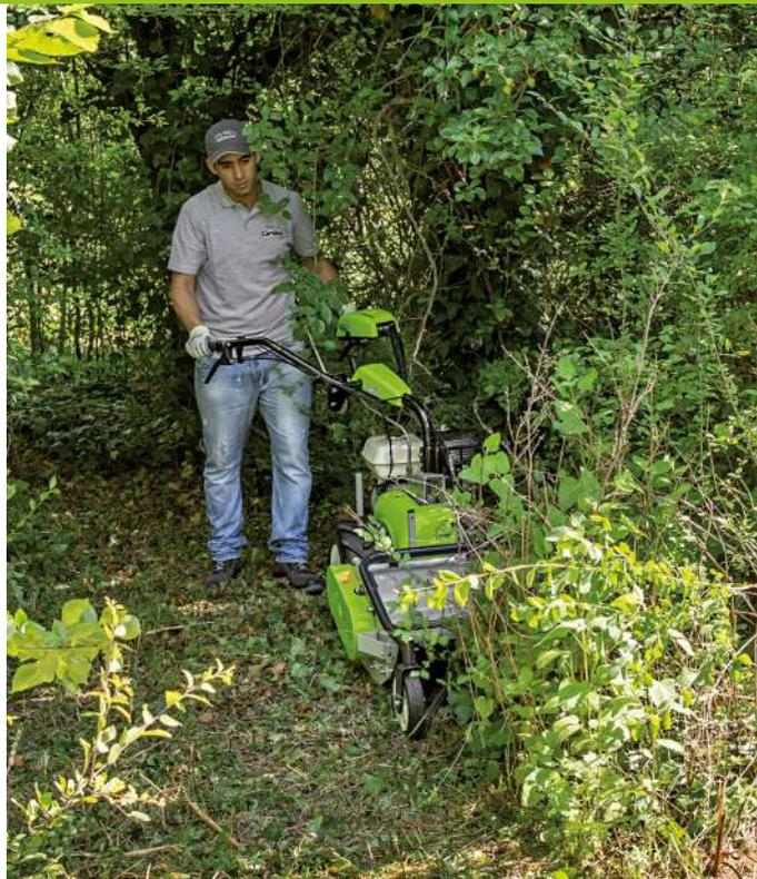
**GH 7 et GH 9** sont équipés d'une prise de force avec couplage à 3 dents qui permet l'utilisation de plusieurs accessoires.
