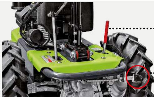
Ce modèle est équipé d'un **frein de stationnement** capable de bloquer la machine même en pente.
