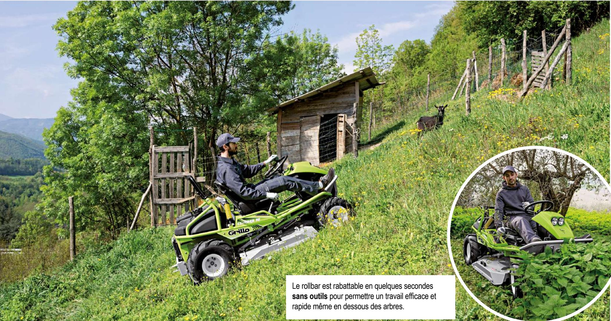
Le rollbar est rabattable en quelques secondes **sans outils** pour permettre un travail efficace et rapide même en dessous des arbres.
