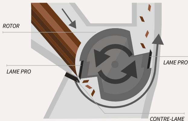
Les broyeurs GTM Professional sont équipés d'un système de broyage par rotor. Il s'agit d'un tambour métallique sur lequel sont montés deux couteaux PRO qui tournent à grande vitesse face à la contre-lame. En raison de l'effet de traction de ce système et de la gravité, les branches sont automatiquement tirées vers l'intérieur.
