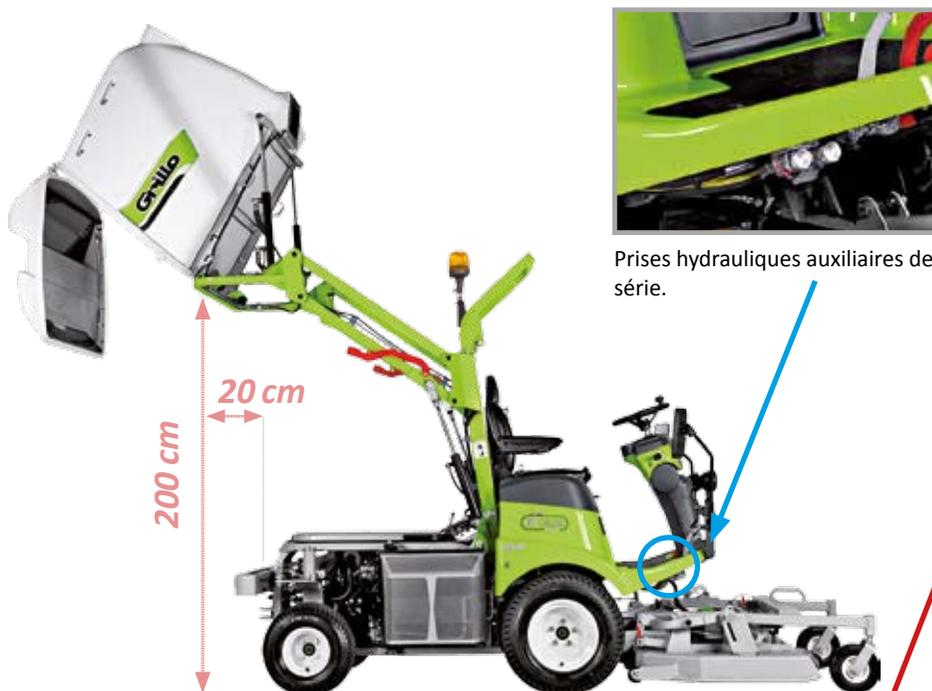
Prises hydrauliques auxiliaires de série.
