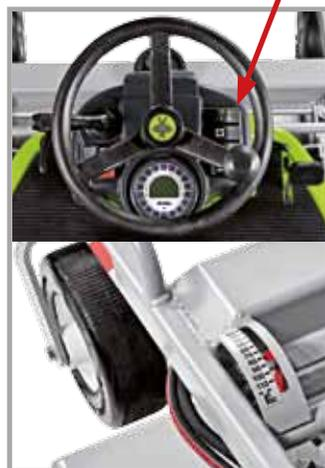
Réglage électro-hydraulique de l'hauteur de coupe
