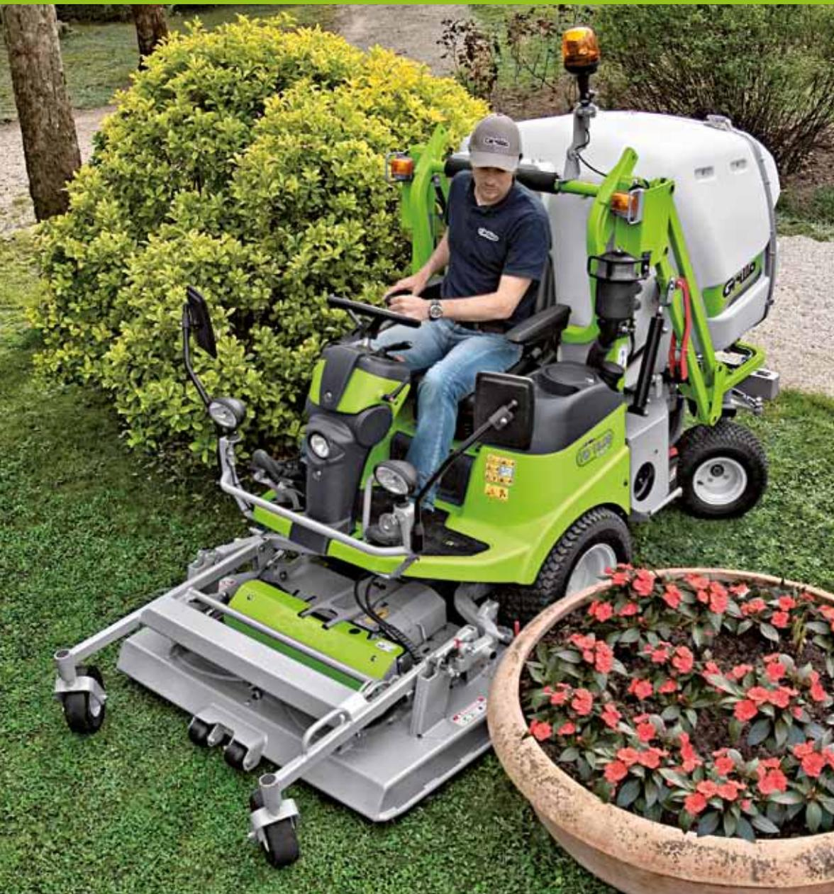
La **FD 13.09** est une tondeuse compacte, avec un **empattement extrêmement réduit, direction assistée et rayon de braquage de seulement 31 cm.**
