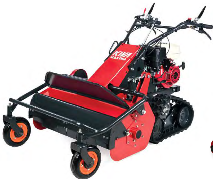
Rotor à fléaux de 80 cm de large
