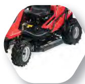
Pont avant pour 4 roues motrices
