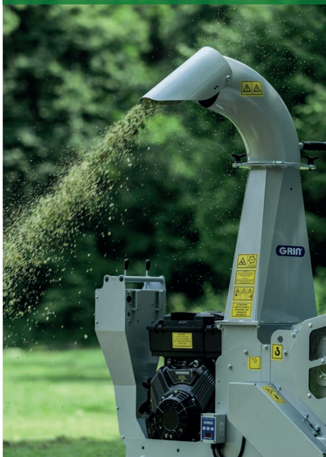
01. BUSE D'ÉVACUATION AVEC ACCÈS LARGE
