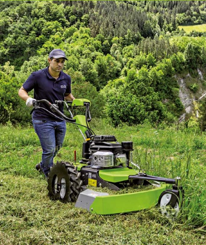
La **CL 62M** reçoit un moteur à essence OHV mono-cylindre, 179 cc et 4,5 HP avec un réservoir de 1,6 lt.
