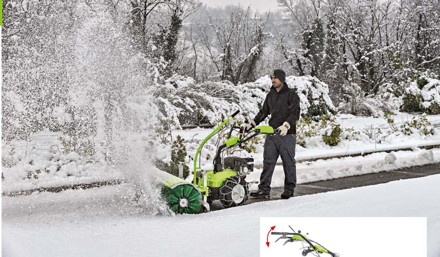
**Un guidon réglable dans toutes les positions:** en hauteur pour le meilleur confort de l'opérateur et en déport pour mieux aider le travail dans les conditions difficiles (par exemple au-dessous des arbres).
