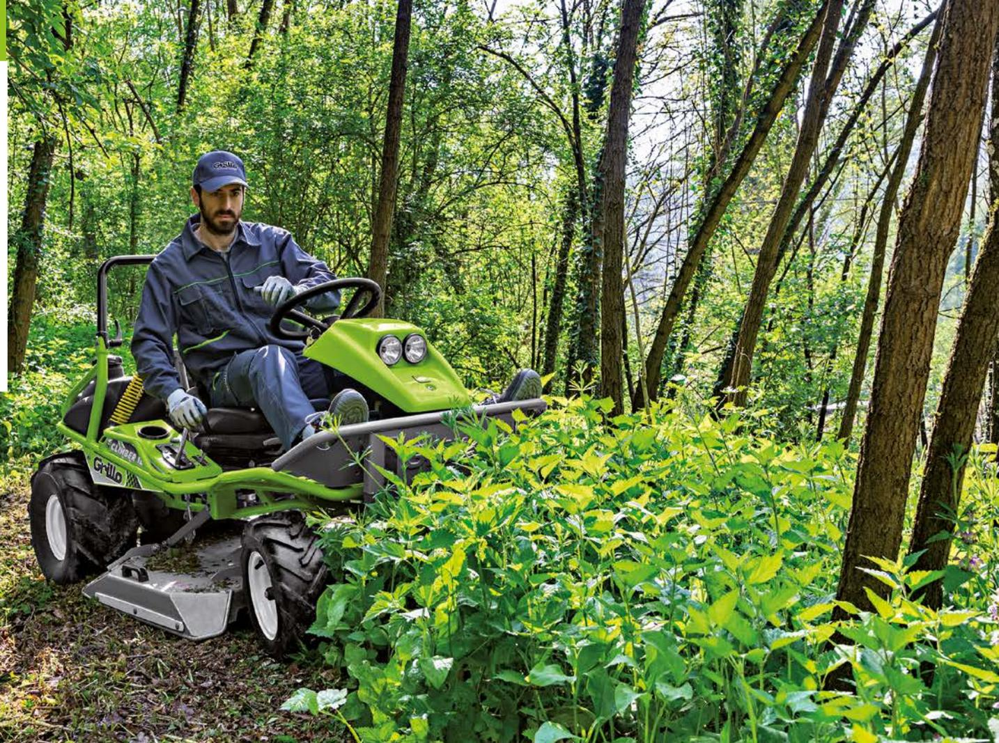
**La hauteur de coupe** se règle par un levier assisté avec système de verrouillage de la hauteur dans n'importe quelle position. Le plateau est bloqué lorsqu'on relâche le levier. **L'embrayage des lames est électromagnétique** avec frein de lame intégré et l'enclenchement s'effectue par un bouton à côté du volant. La largeur de travail est de 93 cm pour le modèle 10.22 et 98 cm pour le 10.27.
