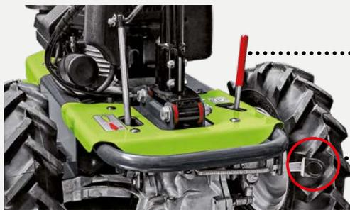
Ce modèle est équipé d'un **frein de stationnement** capable de bloquer la machine même en pente.
