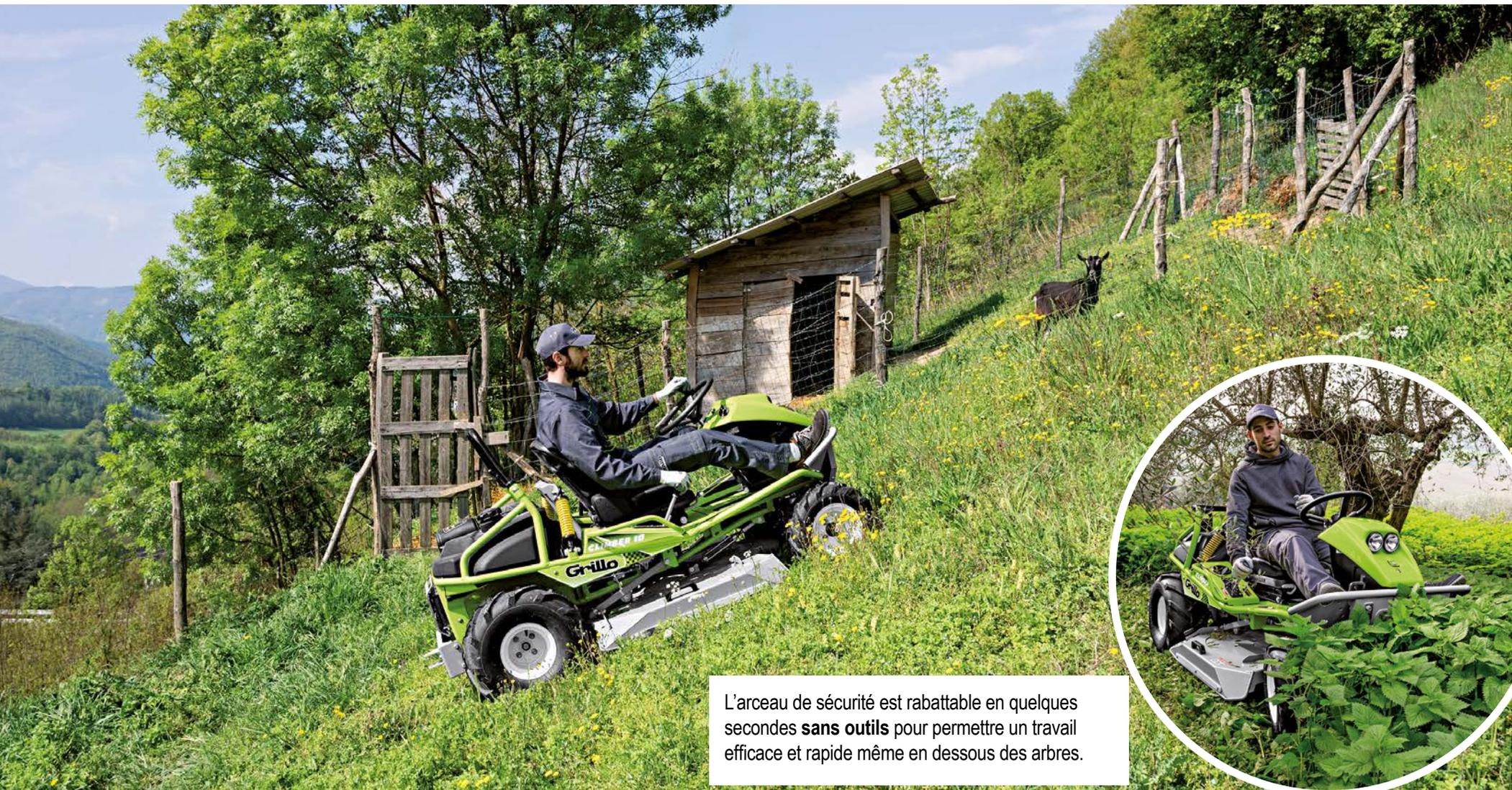
L'arceau de sécurité est rabattable en quelques secondes **sans outils** pour permettre un travail efficace et rapide même en dessous des arbres.
