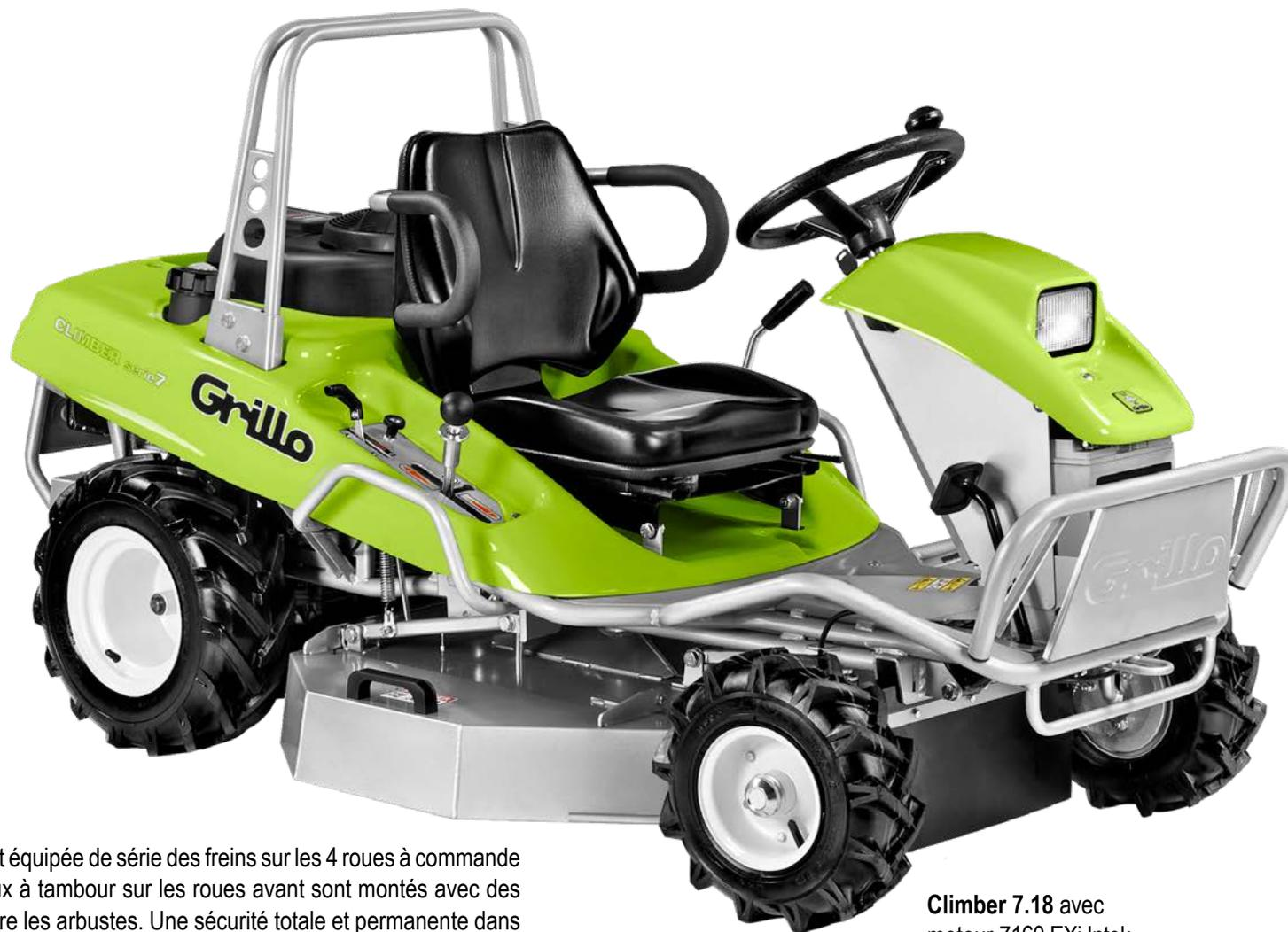
La **Climber 7** est équipée de série des freins sur les 4 roues à commande par pédale. Ceux à tambour sur les roues avant sont montés avec des protections contre les arbustes. Une sécurité totale et permanente dans les fortes pentes ainsi que dans les conditions de faible adhérence.
